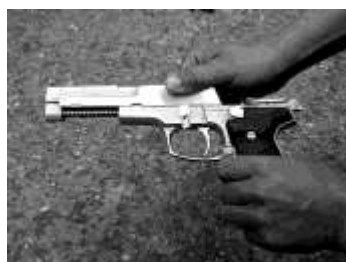
Слика: Склапање пиштоља
